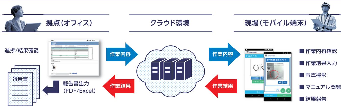
CHECKROIDは、点検・保守業務などフィールドワーク向けにモバイル端末を利用した業務効率化のソリューションサービスです。クラウド環境上のシステムとモバイルアプリケーションを利用し、作業計画から報告まで一貫した業務サポートが可能です。
